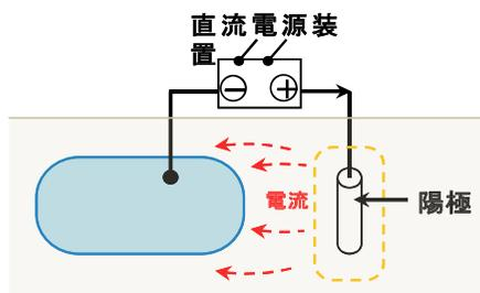
○金属（鉄）の腐食は、土壌のイオン濃度の不均一性等により、埋設された金属の一部分に電流が発生し、鉄がイオン化して溶解するために発生する。
