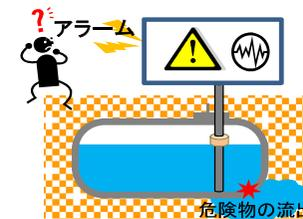
○直径0.3ミリメートル以下の開口部からの危険物の漏れを常時検知することができる設備（例えば、埋設されたタンクに貯蔵されている危険物の液面を常に計測して、危険物の流出による液面の変化を検知し、警報を発するシステムがある。）
