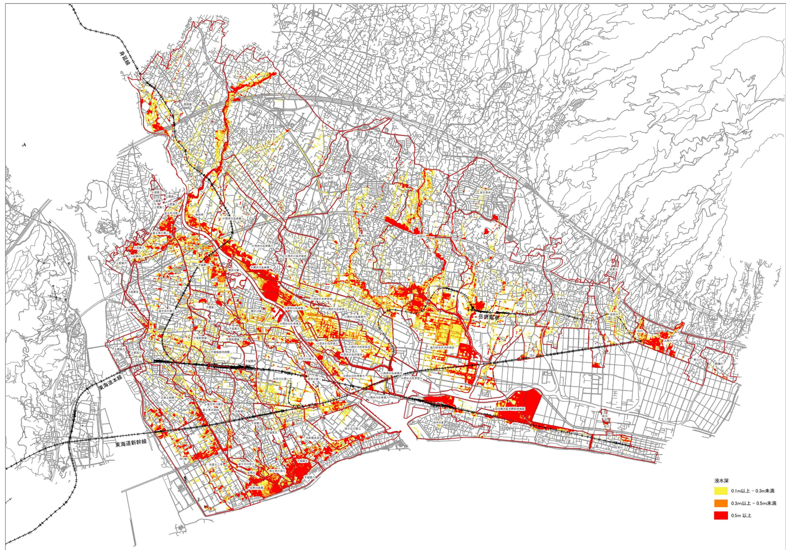
図 3-8 シミュレーション結果(7 年確率降雨時※)
