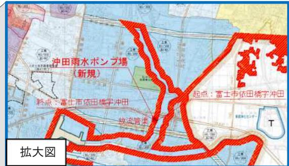
既定の東部処理区排水区域（雨水）約2,821haに変更はなく、放流管渠の起終点と沖田ポンプ場の決定区域を追加しております。
