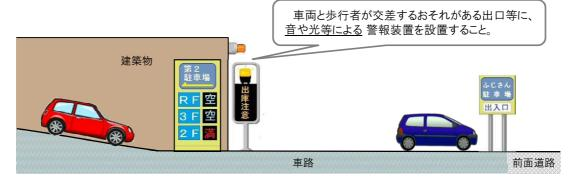
立体駐車場から平面駐車場を通過して前面道路へ出庫する駐車施設の場合は、<u>建築物の出入口</u>に警報装置を設置(建築物からの車両の出入を知らせる必要があるため。)
