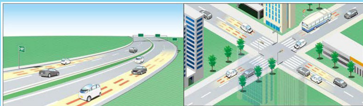
図 6-3 インホイールモーターに走行中に給電するイメージ (出典：国立研究開発法人科学技術振興機構（JST）ウェブサイト)
