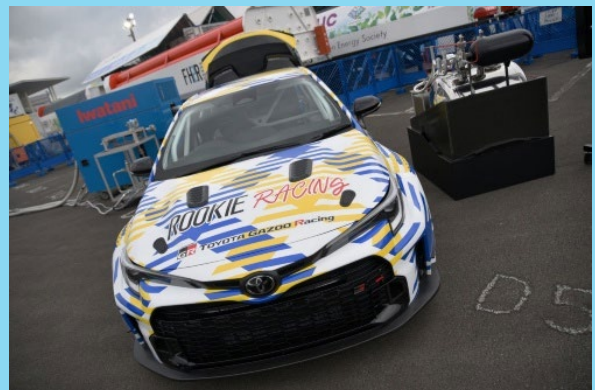
図 6-7 液体水素システムを搭載した「水素エンジンコローラ」 (出典：日経クロステック)
