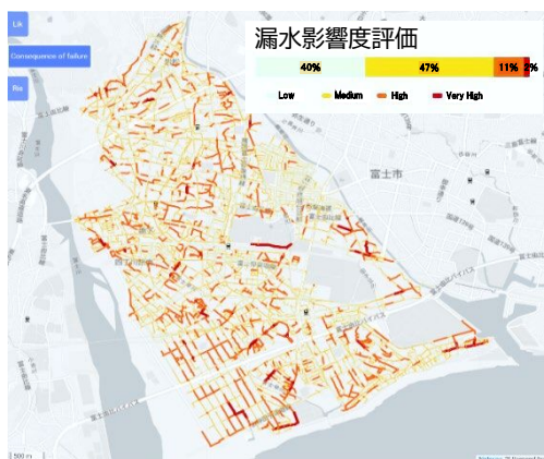
図4-12 AI や環境データを用いた配水管のリスク評価(漏水影響度評価)イメージ
