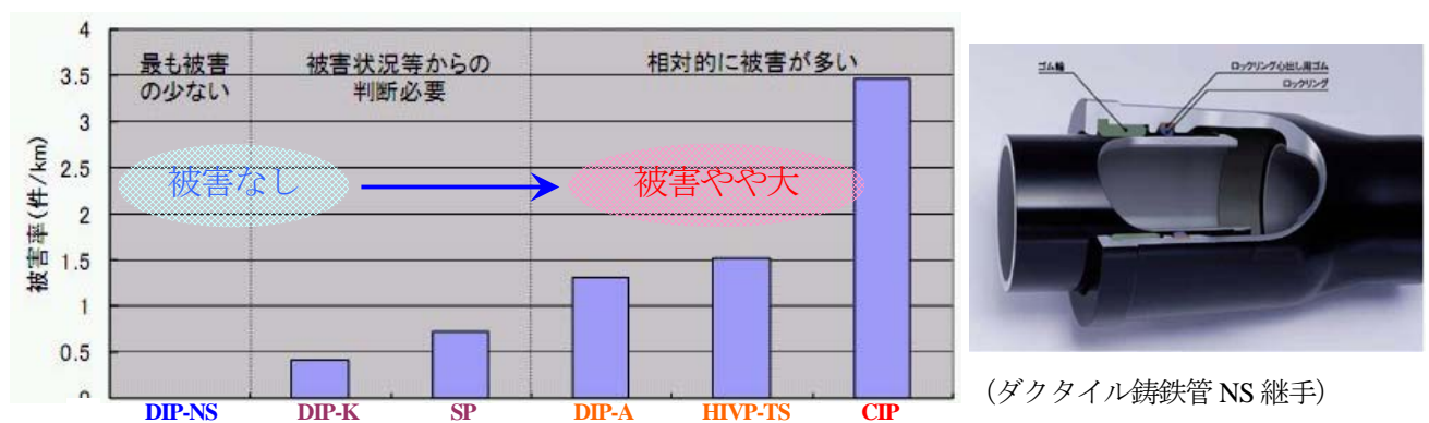
図 4.2 悪い地盤における管種と被害の関係（兵庫県南部地震）
