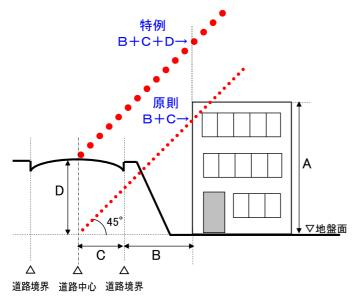
原則として、建物の高さ(A)が、道路の中心から建築物までの距離(B+C)を越える建築物が対象となるが、敷地の地盤面が道路より低い場合は、特例として、地盤面から道路面までの段差(D)の分だけ緩和する。
