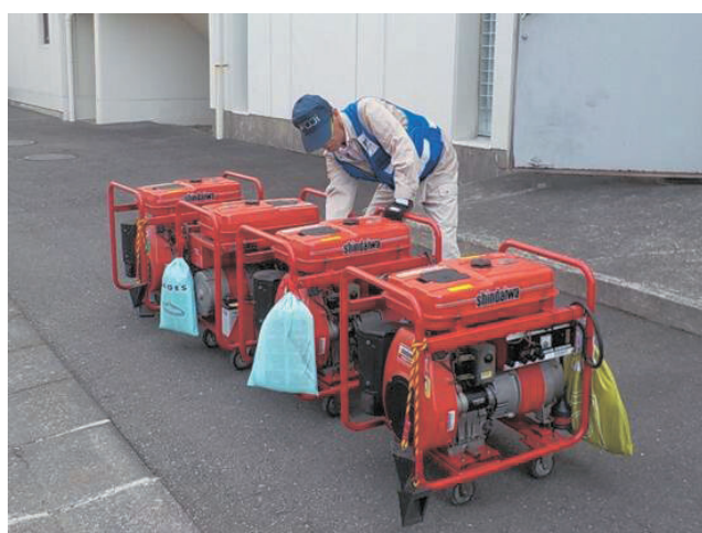
図 3.22 可搬式非常用自家発電機の試運転
