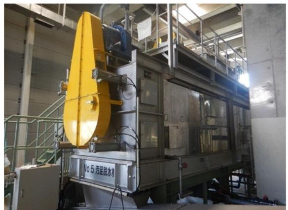
図 高性能脱水機
