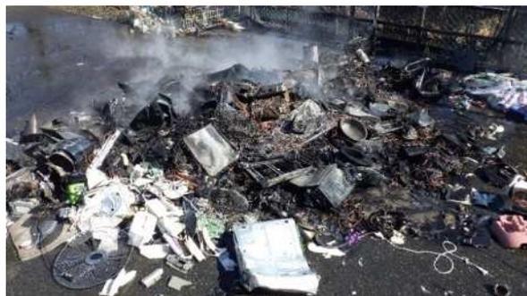
図 3-58 リチウムイオン電池が原因とみられる火災
