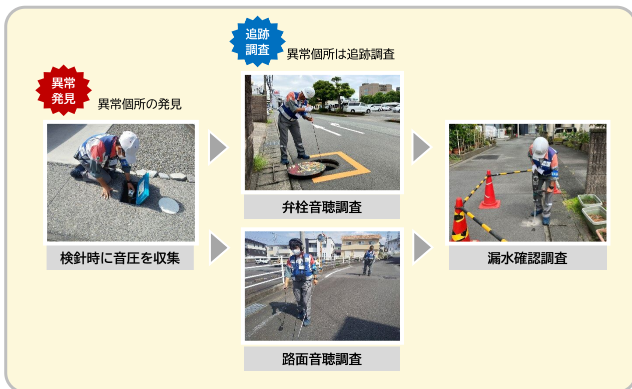
図4-13 検針時同時漏水調査イメージ
