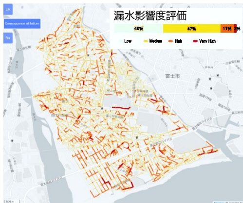
図4-12 AI や環境データを用いた配水管のリスク評価(漏水影響度評価)イメージ
