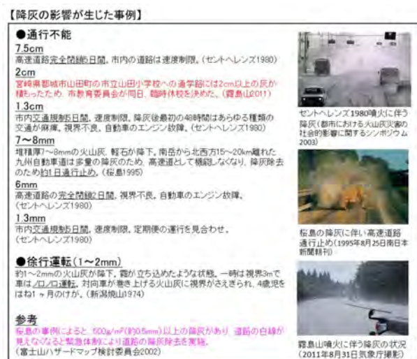
図4 <道路への影響が生じる降灰堆積厚>
