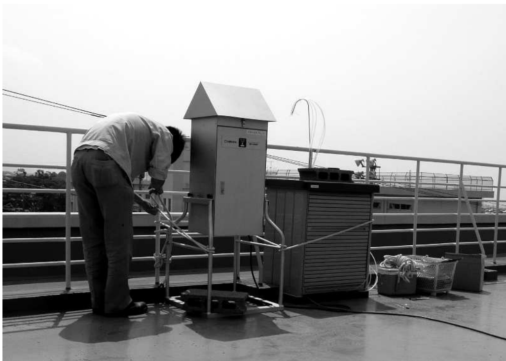
有害大気汚染物質測定の様子（ハイボリウムサンプラーを使用）
