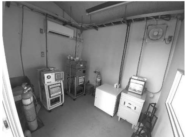
測定局の内部（測定器と記録計）
