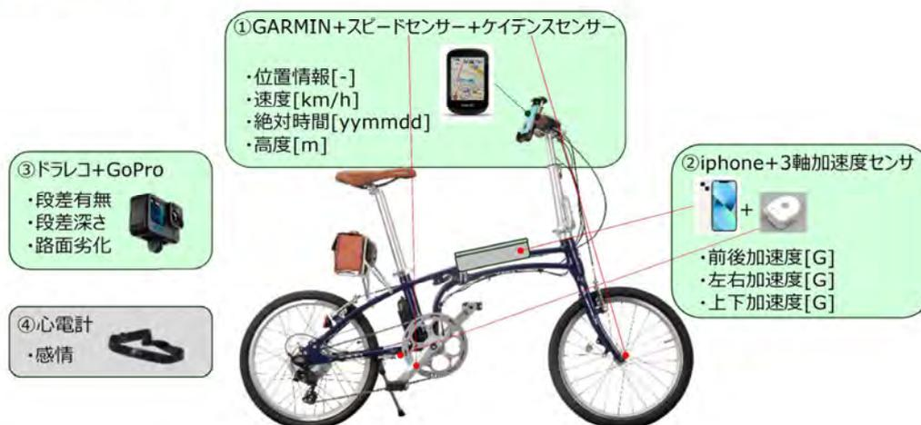
図 4-207 レンタサイクルに搭載した計測機器と取得データ
