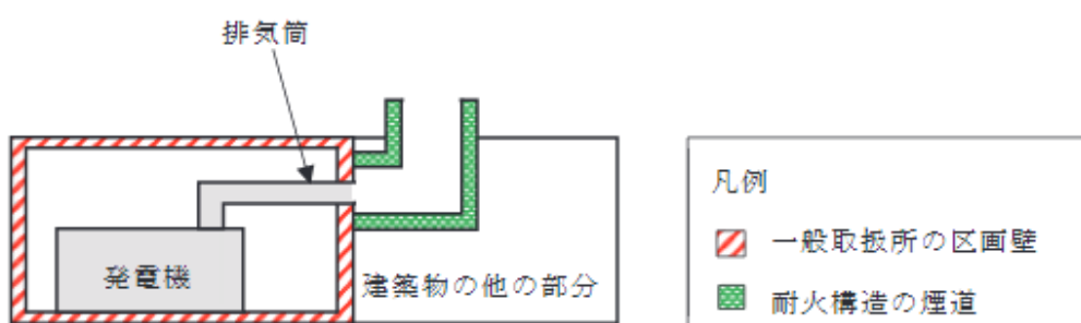
第4-12図 耐火構造の煙道を設ける方法
