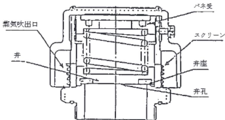
第 10-4 図 安全装置の構造例
