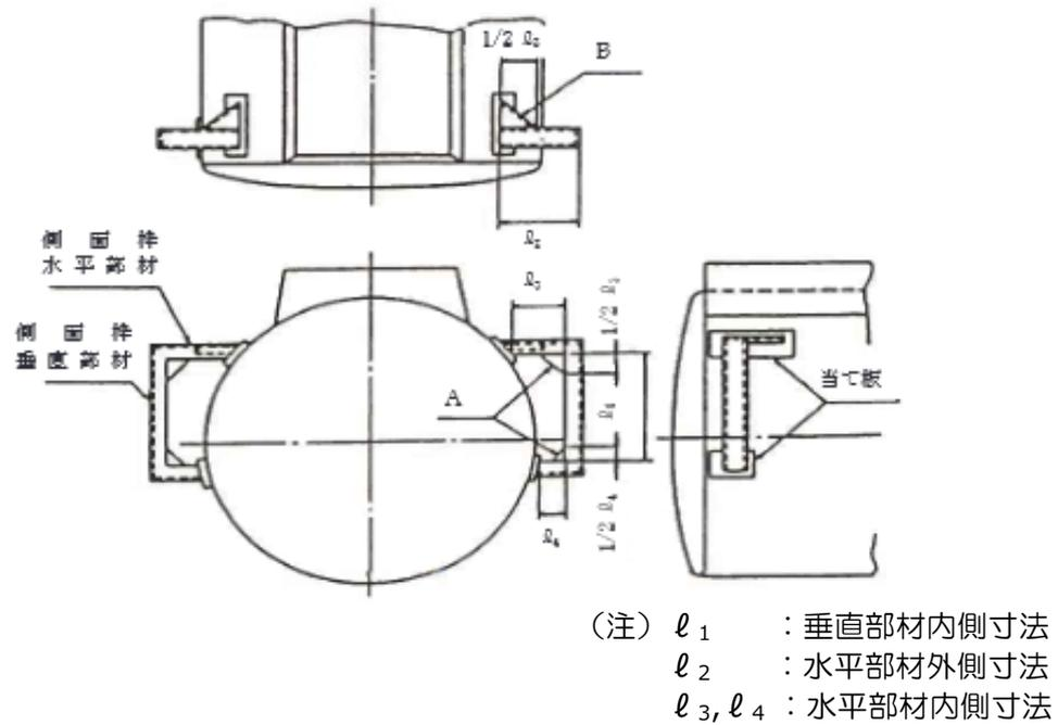
第10-14図 枠型の側面枠の構造例
