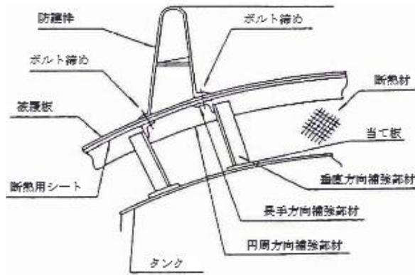
第10-28図 被覆板の下部に補強部材を設ける防護棒(ボルト締め接合する場合)
