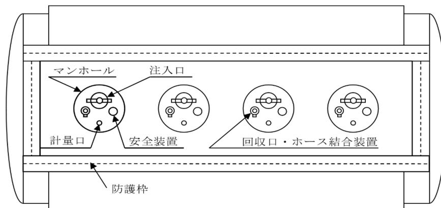
第10-8図 回収口に直接回収ホースを結合する方式の例
