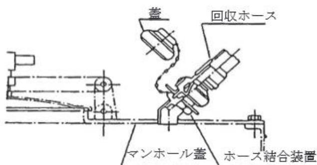
第10-9図ホース結合装置の構造の例
