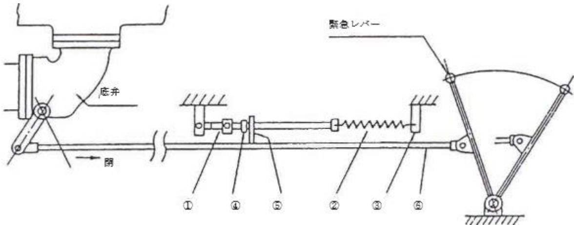
易溶性金属①が火災によって加熱され溶断すると、易溶性金属と接続されているばね②がばね固定ピン③の方向に縮むので、ストッパ④が受金⑤、ロッド⑥を押し動かすこととなり、底弁が自動的に閉鎖される。
