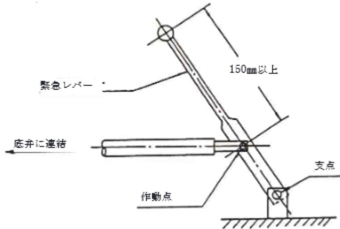
第10-34図 緊急レバーの構造
