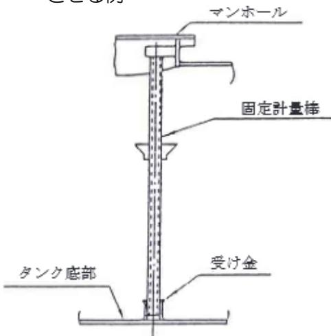
例8 不燃性ガスを封入した状態のままで計量でき、計量棒がタンク底部と接触しなくてもよい例
