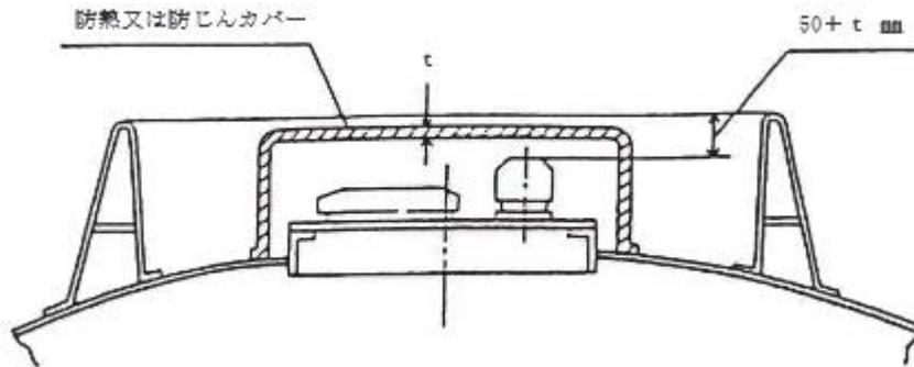
例2 内側に断熱材が張り付けられているもの
