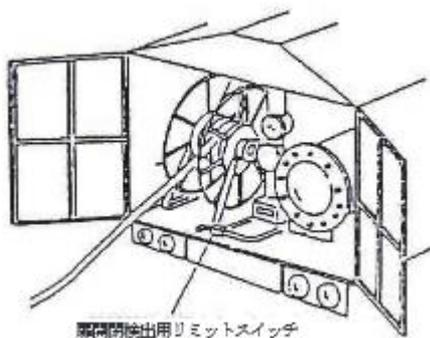
例2 扉のロック用爪の掛け外しによって扉の開閉を検出する方法
