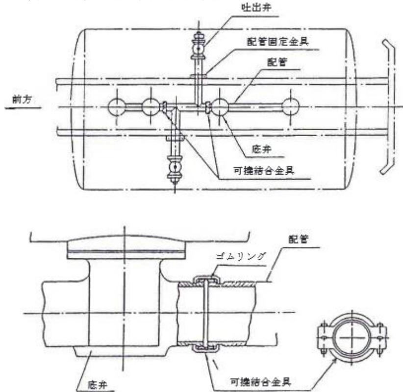
第10-41図 緩衝用継手による方法
