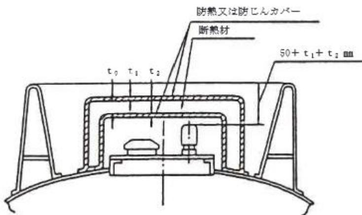
第10-25図 簿黄熱又は防じんカバーを設ける移動貯蔵タンクの防護枠
