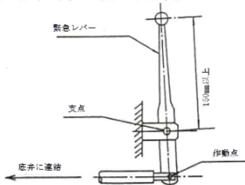
第10-33図 手動底弁閉鎖装置の構造例
