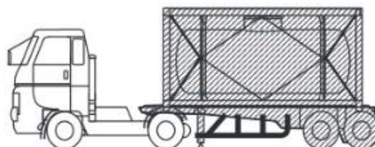
■ = 移動タンク貯蔵所として規制される部分
