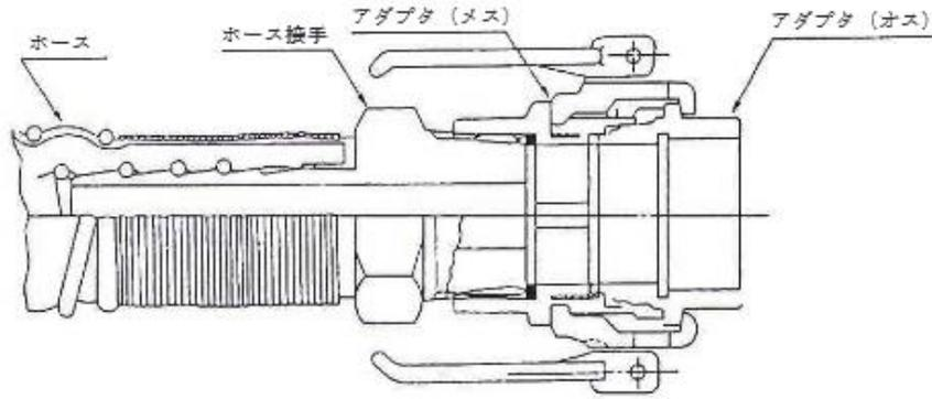
第10-43図 突合わせ固定式結合金具の構造例
