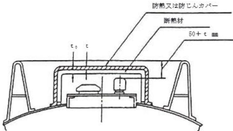
例3 防熱又は防じんカバーの間に断熱材が張り付けられているもの
