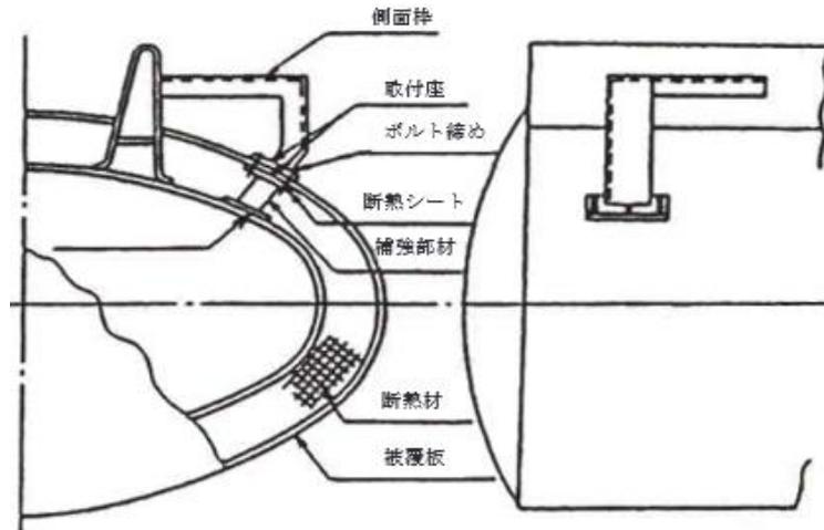
例2 枠型側面枠の場合
