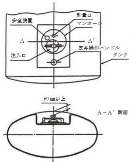
第10-24図 付属装置が陥没しているタンクの例
