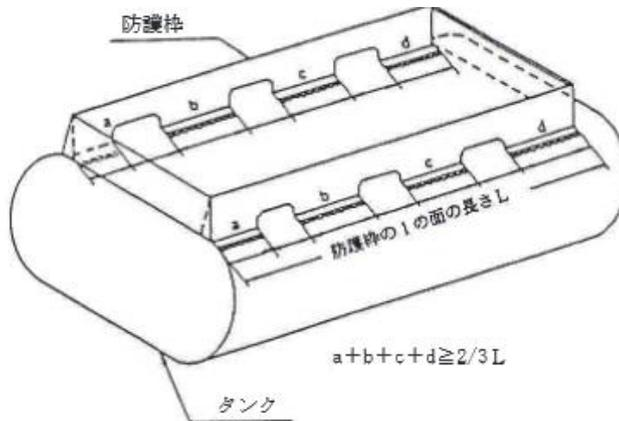
第10-30図 防護棒とタンク胴板との間の溶接部の減少例
