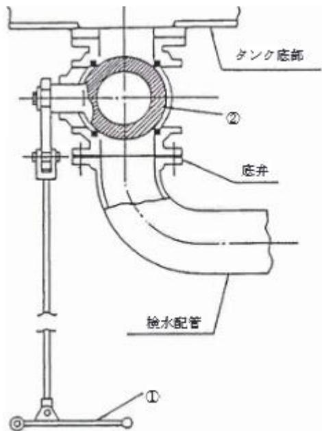
地盤面からレバー（緊急時併用）①を操作して弁口②を開閉する。緊急時には、緊急レバーによりレバー①を操作して、弁口②を閉じる。
