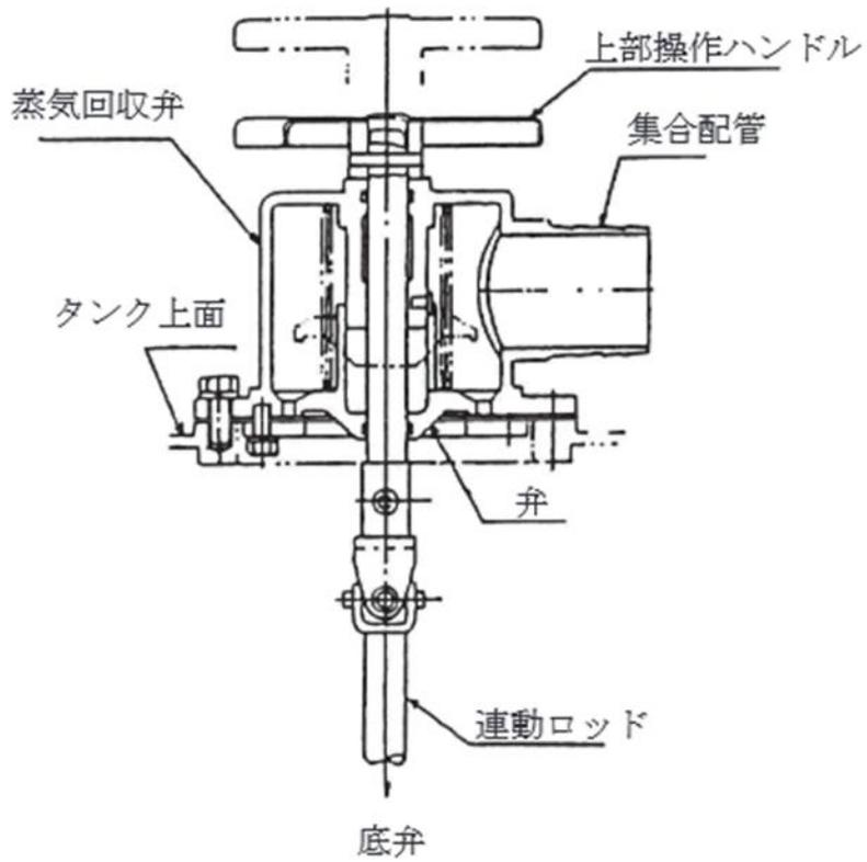
第10-11図 蒸気回収弁の構造例
