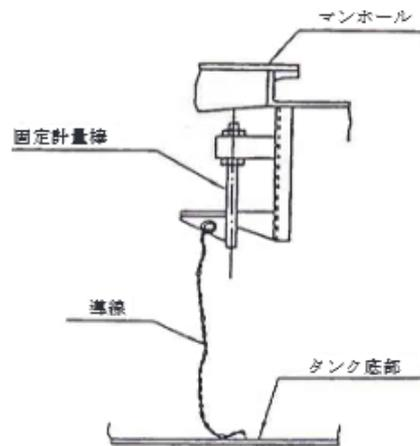
例7 固定計量棒をタンク下部に接触させる例
