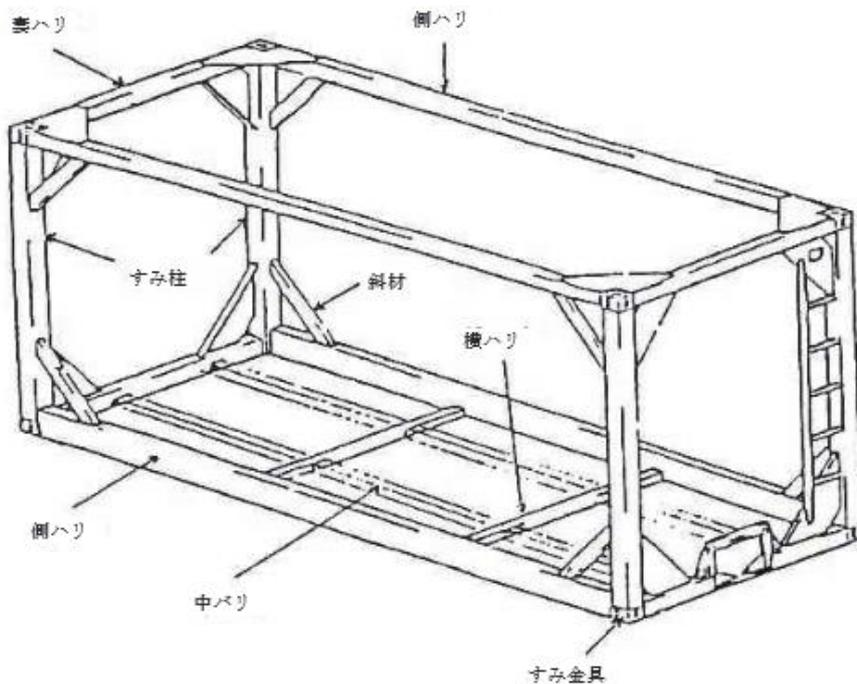
第10-60図 箱枠の部材名称及び構造
