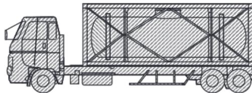
■ = 移動タンク貯蔵所として規制される部分
