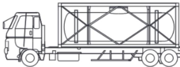
エ 被けん引車形式で積載式の移動タンク貯蔵所
