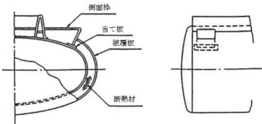
第10-21図 タンク胴板に直接取り付ける側面枠の例
