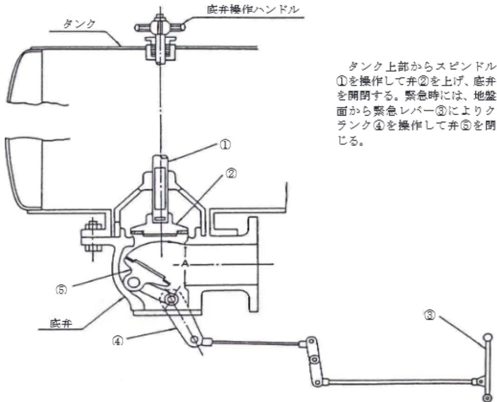
例2-1 地盤面上において底弁を開閉する構造のもの
