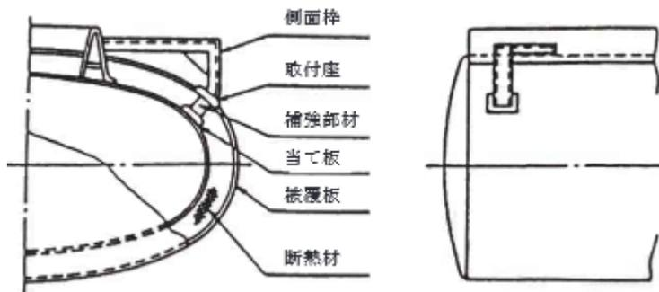
第10-19図 外板の下部に補強部材を設ける側面枠の例
