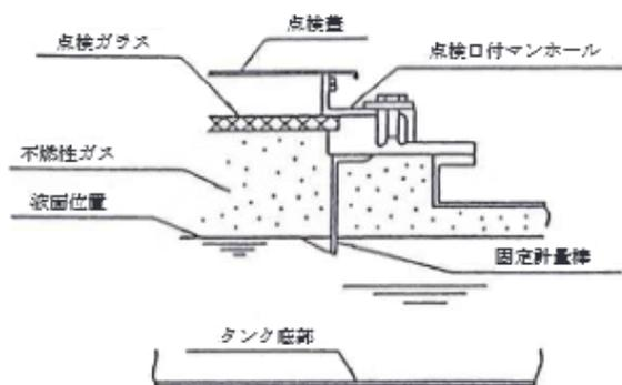
第10-47図 計量時の静電気による災害を防止するための措置
