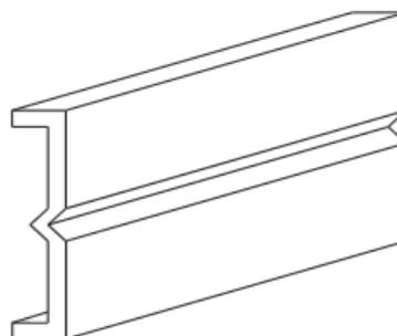
第 10-5 図 防波板の構造
