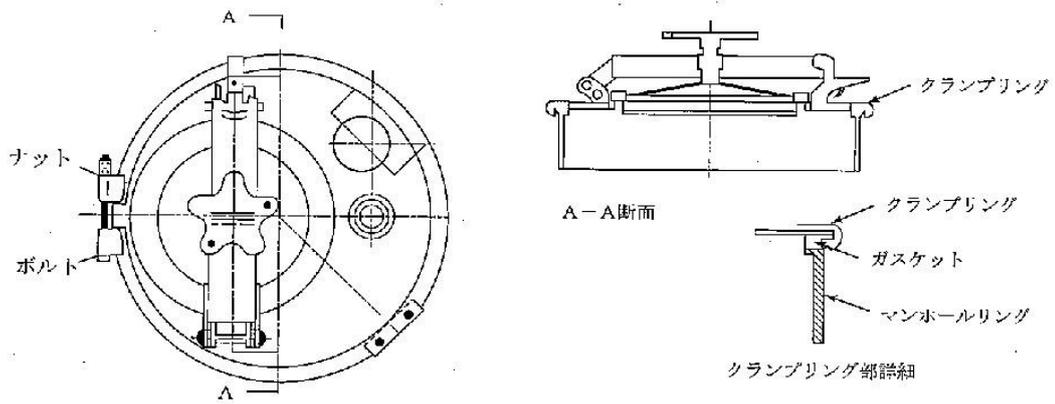
第10-7図 クランプリング方式のマンホールカバーの例
