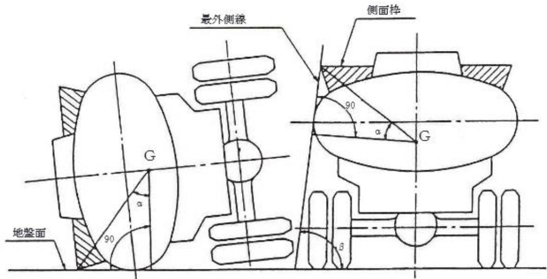
第10-17図 側面枠頂点取付図
