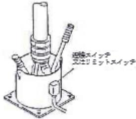
例2 クランプ式ノズル格納具の場合
