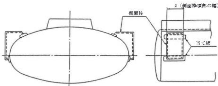
第10-13図 箱形の側面枠構造例
