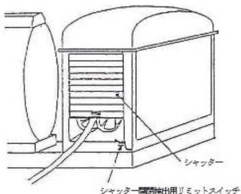
第10-66図 給油設備の扉による方法の例
