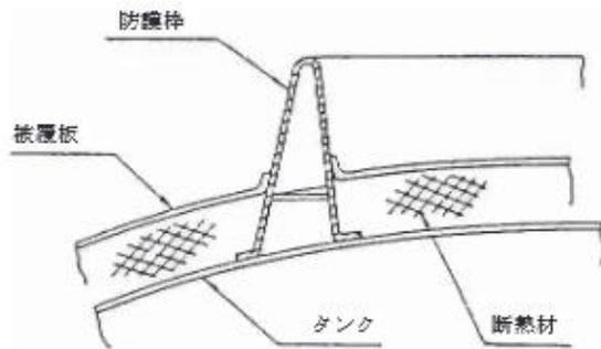
第10-29図 タンク胴板に直接取り付ける防護棒
