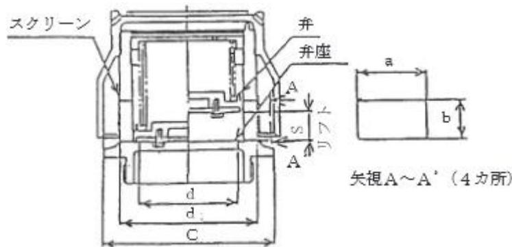
(e) 有効吹出し面積は、2個以上の安全装置によって確保することができる。この場合は、それぞれの安全装置の有効吹出し面積の合計が所定の有効吹出し面積以上となれば足りる。
