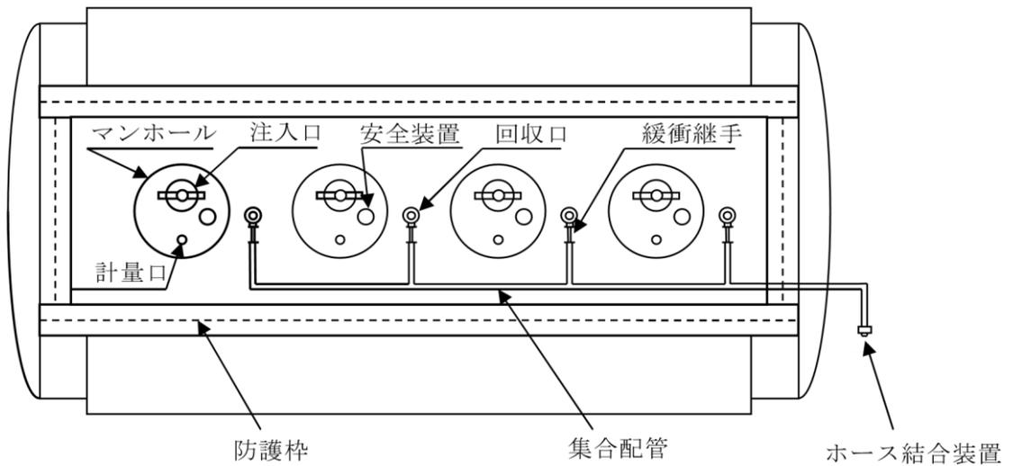
第10-10図 集合配管の取り付け例
