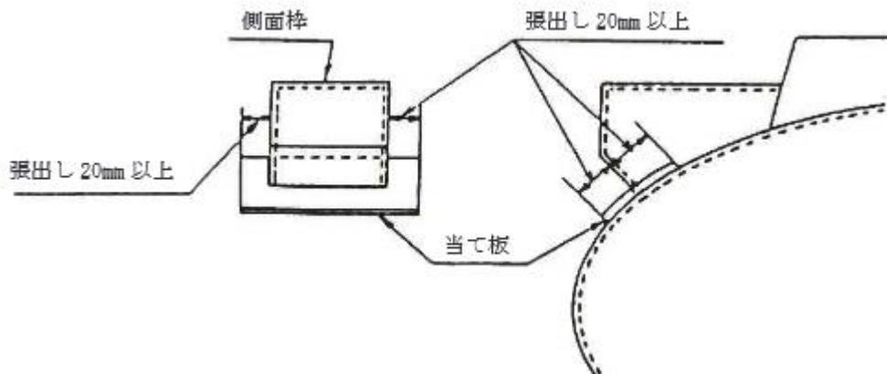
例2 枠形の側面枠に設ける当て板
