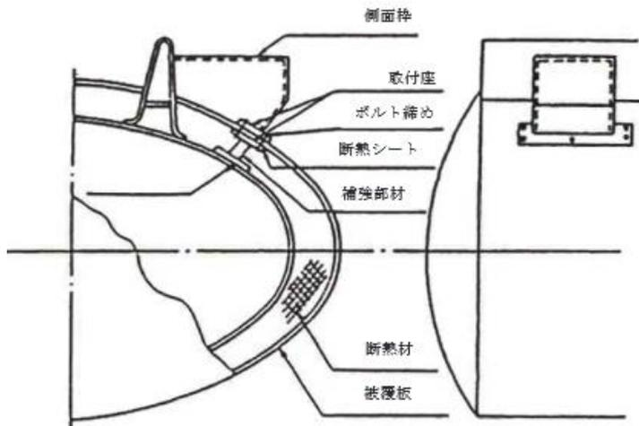
第10-20図 外板の下部に補強部材を設ける側面枠の例
