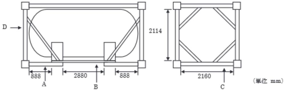
移動貯蔵タンクの移動方向に平行な荷重に対するはり下けたAの強度計算例
