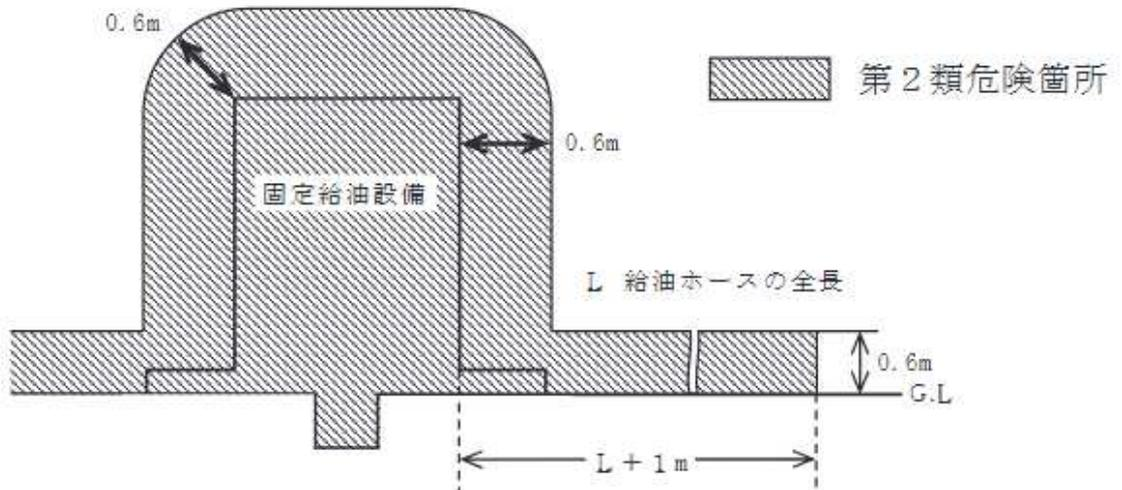
第17-4図 地上式固定給油設備（可燃性蒸気流入防止構造以外）
