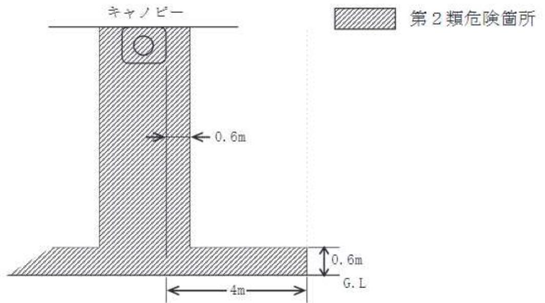
第17-9図 懸垂式固定給油設備（可燃性蒸気流入防止構造以外）
