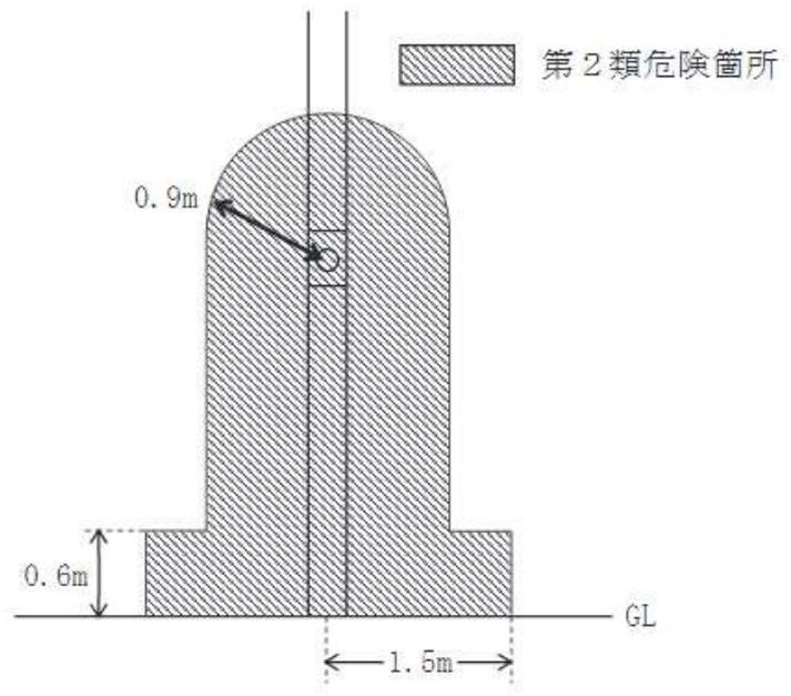
可燃性蒸気回収接続口
