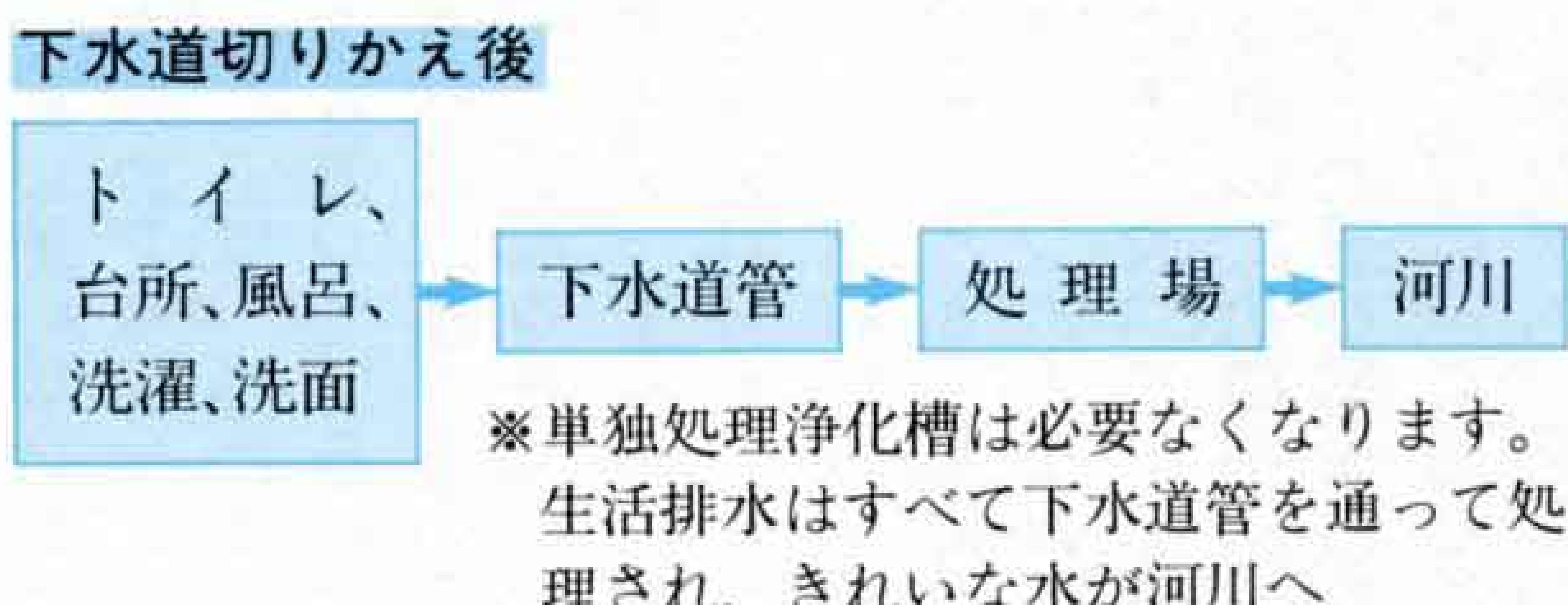
\***下水道管**—地下を通っている管。家庭や事業所などから流された污水を下水処理場まで流します。
