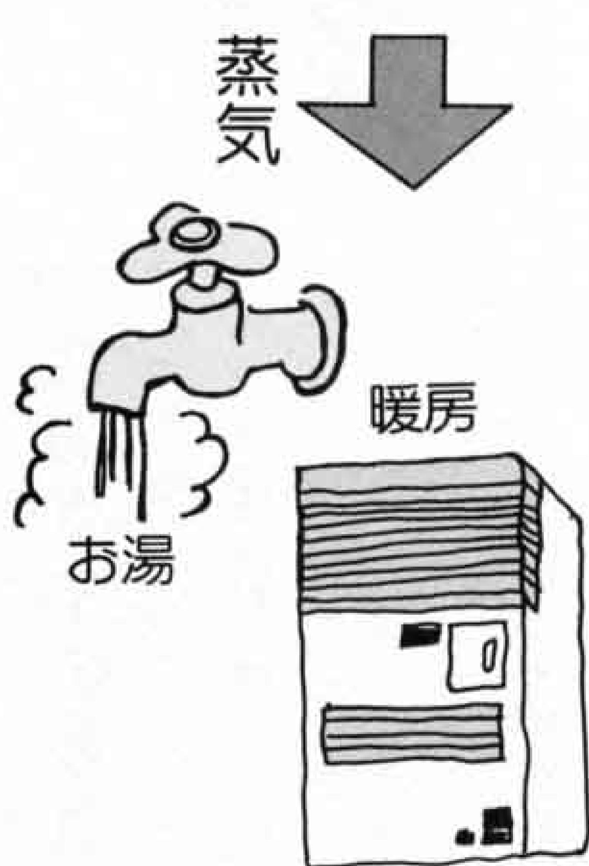
蒸気の熱で、第一清掃工場内の暖房、給湯や、富士ハイツと温水プールにも熱を送り、ここでも冷暖房、給湯などに利用しています。
