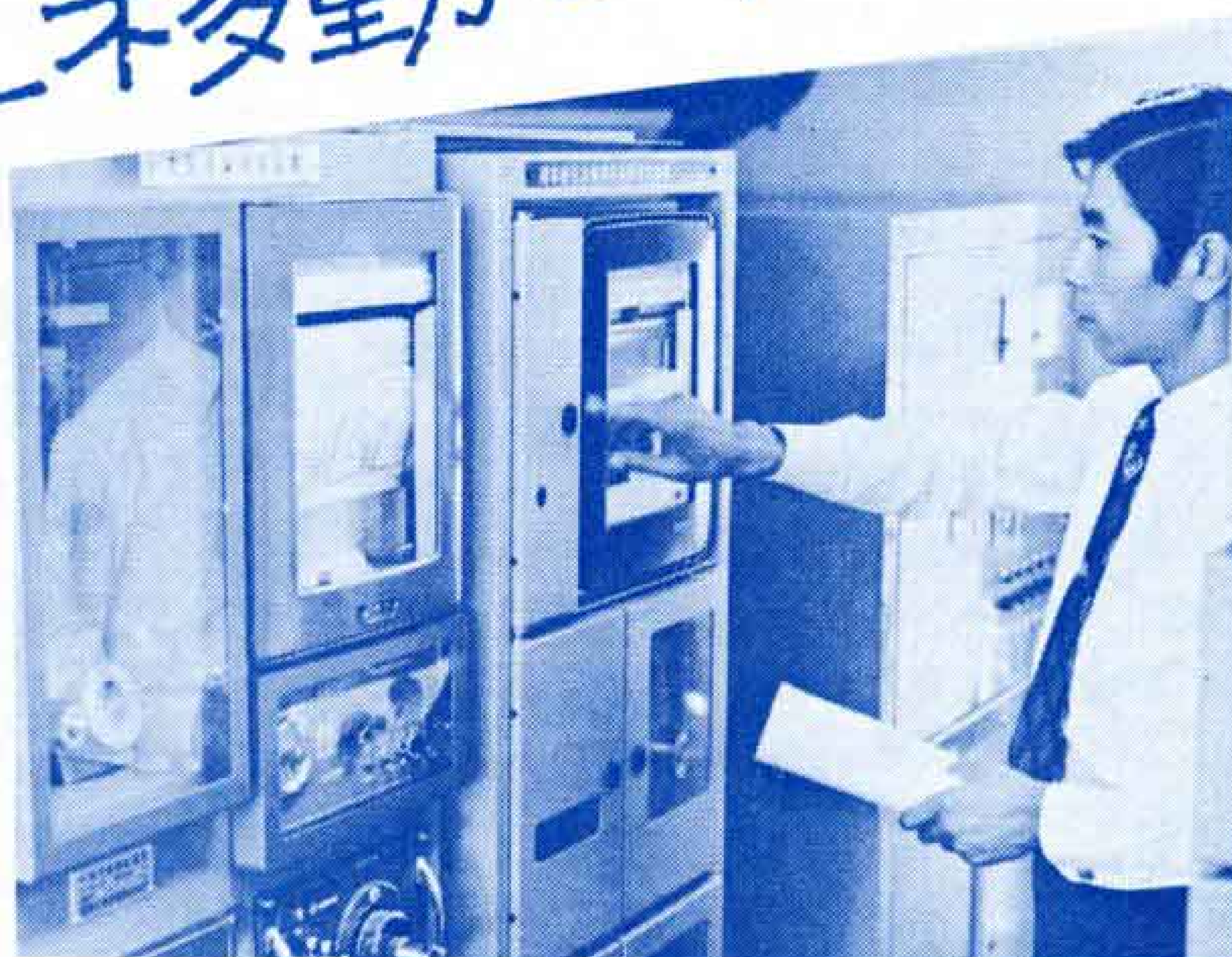
【亜硫酸ガスなど9種類の測定機を登載】
